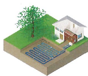
Pompe à chaleur sur capteurs enterrés horizontaux
